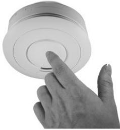
Um den Falschalarm eines RWM (die LED blinkt schnell) abubrechen, drücken Sie den Test-/Stummschaltknopf. Die RWM werden für einen Zeitraum von ungefähr 10 Minuten stumm geschaltet. Die LED auf der Abdeckung des RWM blinkt währenddessen alle 8 Sekunden und kennzeichnet damit, dass das Gerät stumm geschaltet wurde. Der RWM wird am Ende des Stummschaltzeitraums (10 Minuten) zurückgesetzt.
